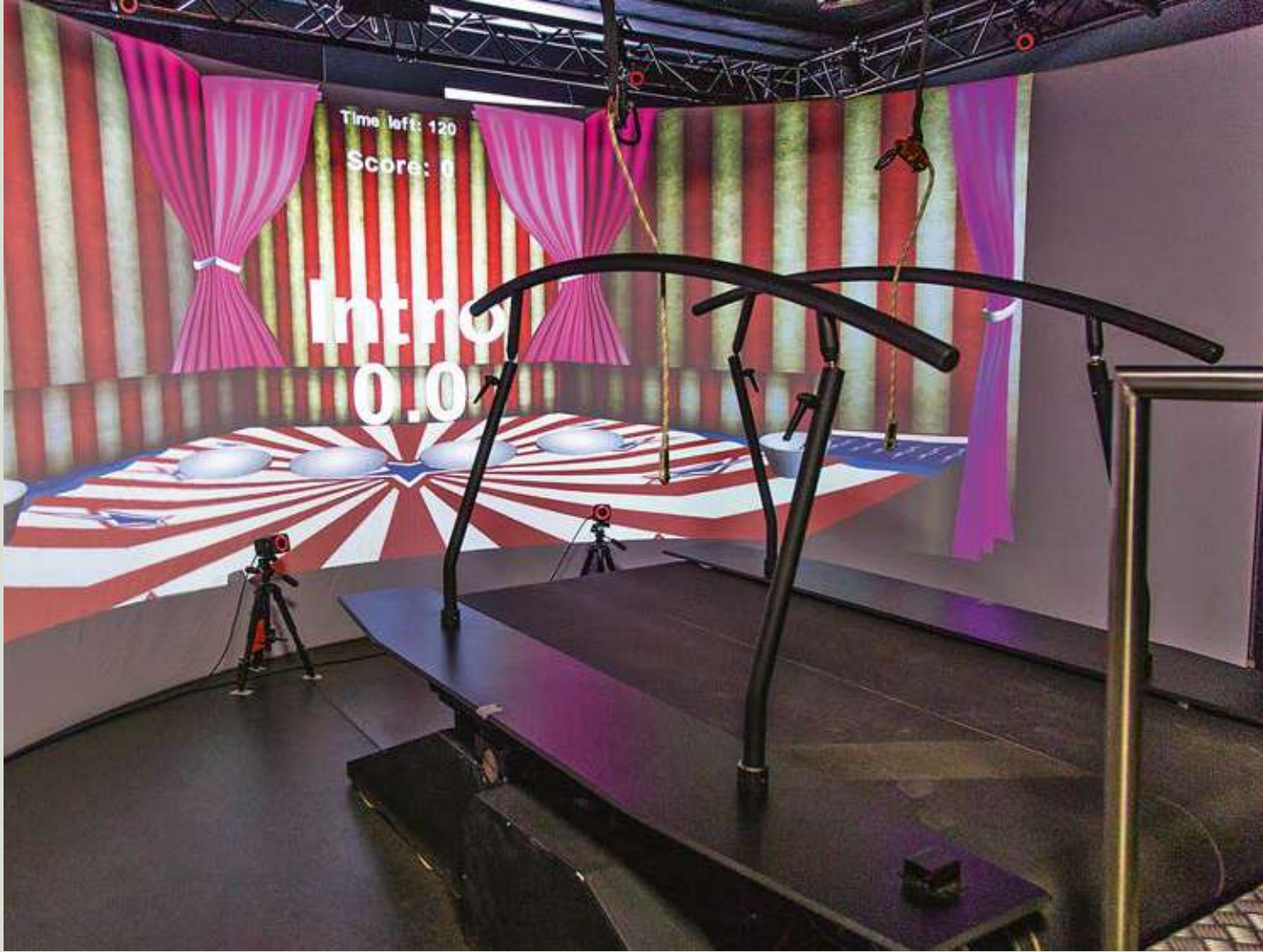
Система Motec обладает возможностью создания среды виртуальной реальности с функцией обратной связи и возможностью захвата движений в режиме реального времени
