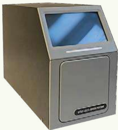
Автоматическая система для проведения «point-of-care» («прикроватных») тестов методом изотермической амплификации для детекции РНК SARS-CoV-2, разработка ФГБУ «ЦСП» ФМБА России совместно с TRDC – Троицким инженерным центром (опытный образец). 2022 год
